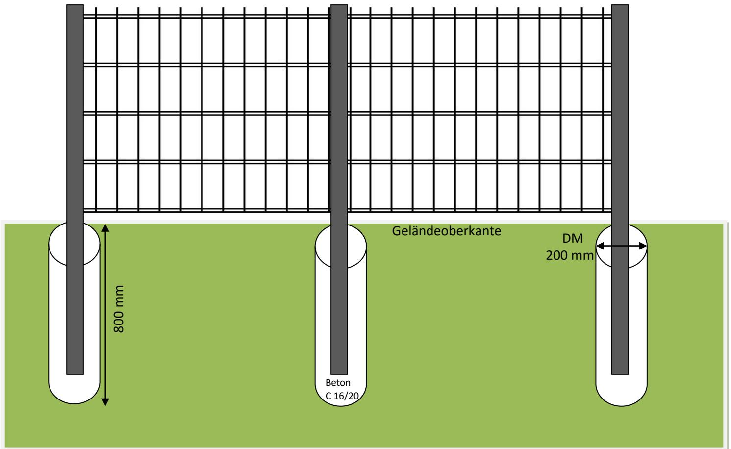
Für das Fundament wird ein 800 mm (frosttief) tiefes und 200 mm breites Loch ausgehoben.
